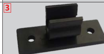
Kolbenhalterung, PA66 Kunststoff, 2 Schraub- oder Klebemontage, für Kolben-Ø 8mm, max. Temperatur 80°C
